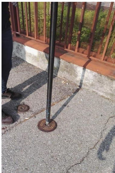
Posizionamento del GPS al centro del chiusino
